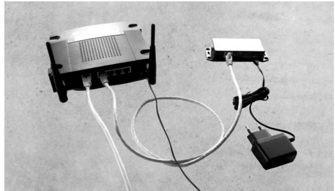
Abb. 3: Verbindung von Netzadapter und LANfunk-Box
