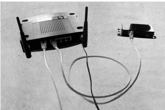
Abb. 2: Verbindung von Netzwerkkabel, LANfunk-Box und WLAN-Router
