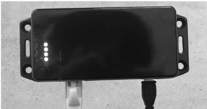
Abb. 7: LANfunk-Box mit 4 leuchtenden LED-Lampen
