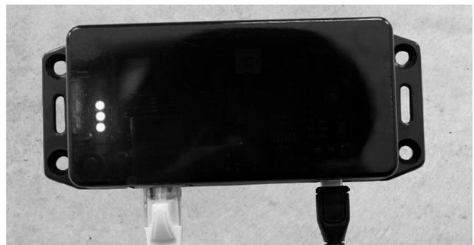
Abb. 5: LANfunk-Box mit 3 leuchtenden LED-Lampen
