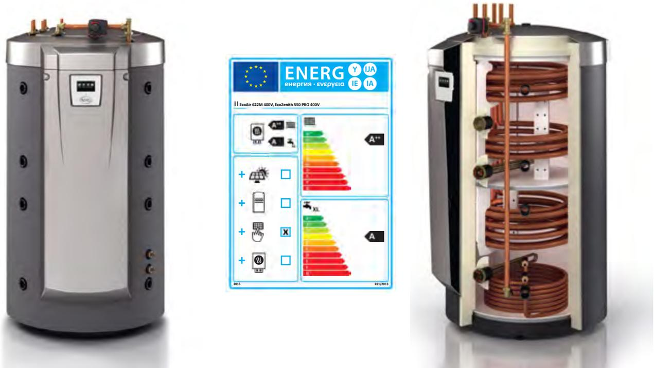
Der MHG EcoZenith i550 Pro ist ein Multi-Funktionsspeicher mit 540 Liter Speicher Inhalt. Warmwasseraufbereitung im Durchlaufprinzip mit zwei Rippenrohrwärmetauscher  $2 \times 18$  m, ca.  $13 \text{ m}^2$ . Solarwärmetauscher 10 m, ca.  $2.8 \text{ m}^2$ . Schichtungslanzen für schnelle Schichtung der Solarerträge. 4 Wege Heizkreismischer (für Heizleistung  $< 28 \text{ kW}$  geeignet) Grössere Heizkreismischer als Option wählbar.
