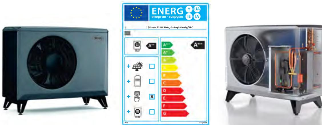
Die MHG EcoAir 600M ist eine modulierende Luft/Wasser Wärmepumpe für die Aussenaufstellung und für hohe Leistungen bei geringer Schalleistung ausgelegt. Die Wärmepumpe verfügt über eine integrierte Heissgas-Abtauung, das den Verdampfer zur Aufrechterhaltung einer hohen Leistungsfähigkeit eisfrei hält. Die Wärmepumpe kann entweder über den EcoLogic Pro angesteuert oder an den EcoZenith i250 L / EcoZenith i350 L / EcoZenith i550 Pro (nur 622M+614M) angeschlossen. Die Leistung
