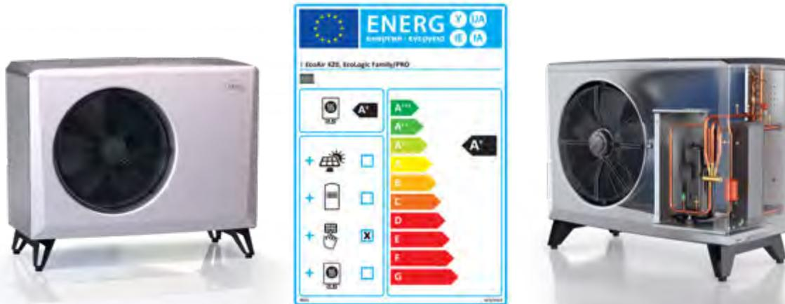
Die MHG EcoAir 400 ist eine Luft/Wasser Wärmepumpe für die Aussenaufstellung und für hohe Leistungen bei geringer Schallleistung ausgelegt. Die Wärmepumpe verfügt über eine integrierte Heissgas-Abtauung, das den Verdampfer zur Aufrechterhaltung einer hohen Leistungsfähigkeit eisfrei hält. Die Wärmepumpe kann entweder an den EcoZeith 250/EcoZenith i550
