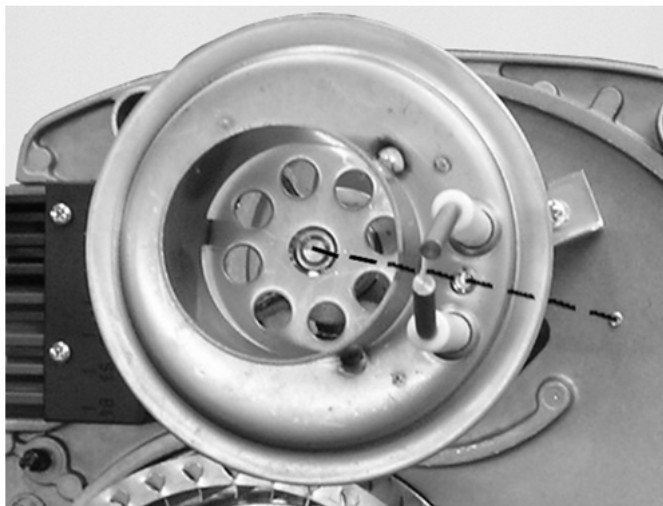
Abb. 25: Mischsystempositionierung und Ausrichtung Zündelektrode
