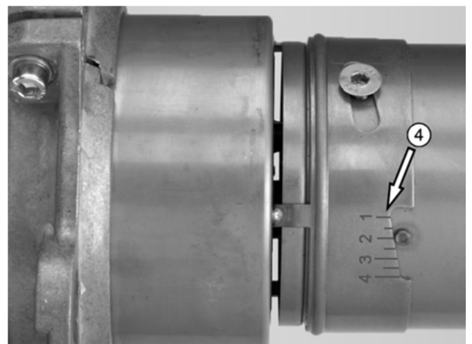
Abb. 7: Rezirkulationsschlitze ③ und Skala ④ zur Einstellung von Maß R
