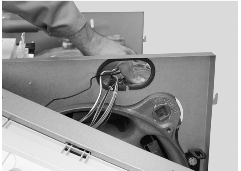
Abb. 50: Kabelbaum durch die Öffnung im Verkleidungsblech hindurchführen.
