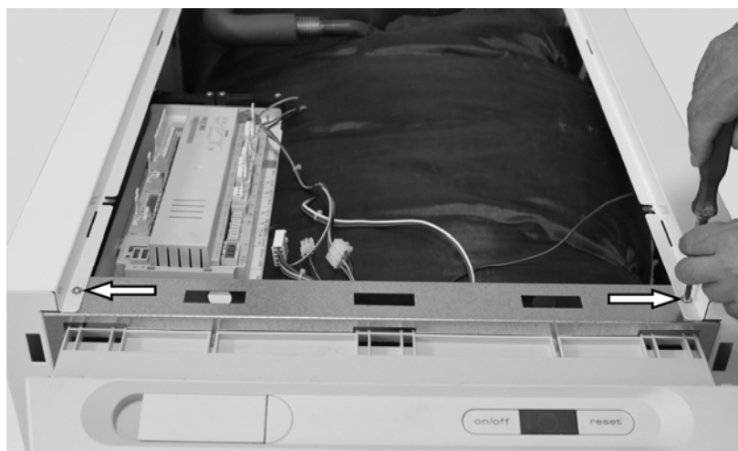
Abb. 28: Seitenverkleidung am Frontblech mit zwei Blechschrauben und Zahnscheiben befestigen.
