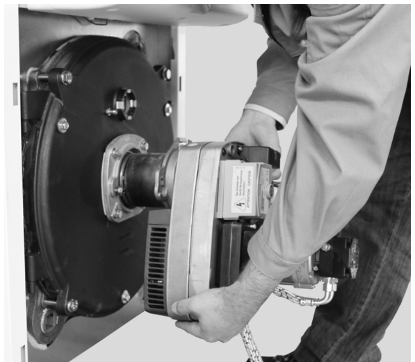
Abb. 63: Den Brenner in die Kesseltür einführen, so dass die Brennerbefestigungsschrauben durch den Klemmflansch hindurch stehen. Anschließend den Brenner links herum drehen und danach die Schrauben festziehen.
