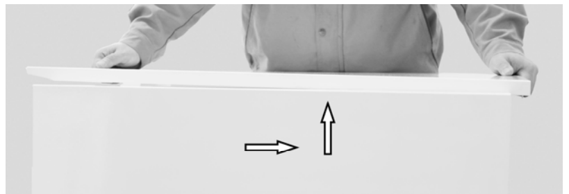
Abb. 19: Oberes Verkleidungsblech nach hinten, anschließend nach oben ziehen und abnehmen
