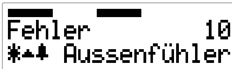
Abb. 14: Beispiel einer eigenen Fehleranzeige
