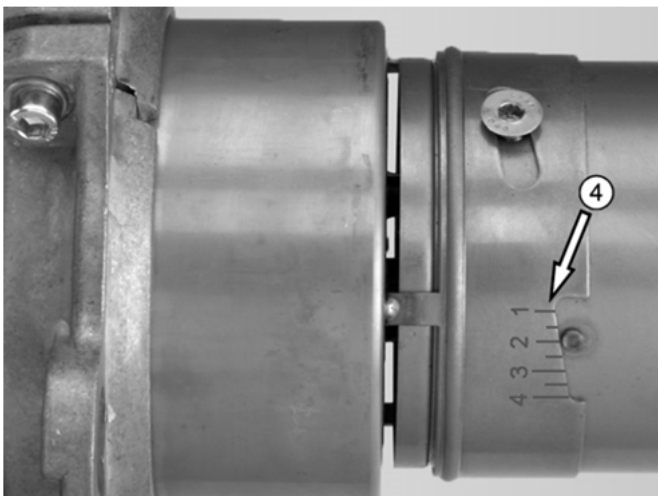
Abb. 13: Rezirkulationsschlitze ③ und Skala ④ zur Einstellung von Maß R
