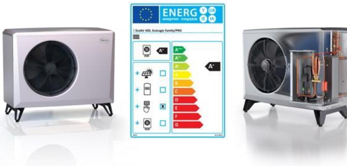
La MHG EcoAir 400 est une pompe à chaleur air / eau modulante pour installation en extérieur conçue pour des performances élevées avec une faible puissance acoustique. La pompe à chaleur est équipée d'un dégivrage aux gaz chauds intégré qui maintient l'évaporateur exempt de glace afin de maintenir un rendement élevé.
