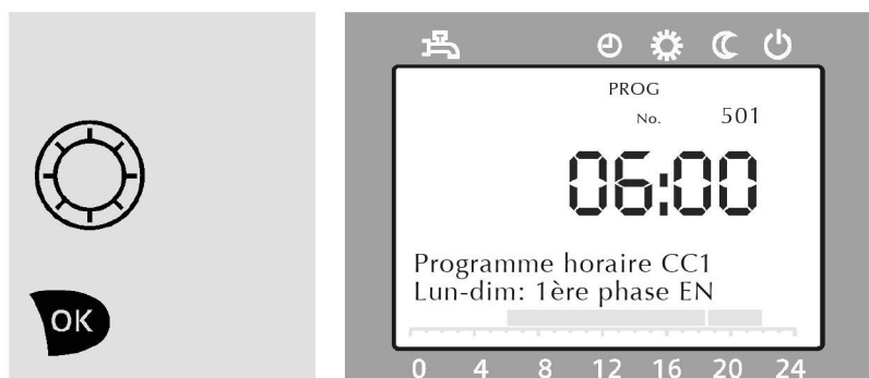
Figure 28 : Tournez le bouton rotatif d'un cran à droite. Le jour choisi ou la partie choisie de la semaine s'affiche ainsi que
