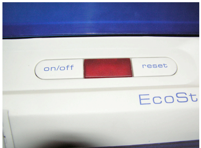
Figure 4 : Commutateur marche/arrêt, voyant anomalie et touche reset sur le panneau de commutation
