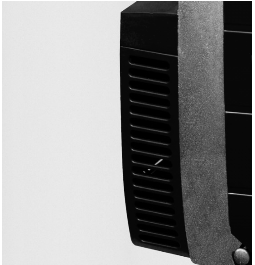
Fig. 29: Silencieux d'aspiration d'air RE 1H / HK / HG avec capot
